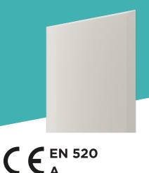
Lastra di tipo A costituita da un nucleo in gesso emidrato reidratato, additivato con fibre di vetro, rivestito su entrambe le facce da materiale cellulosico con funzione di armatura esterna. La lastra ha un contenuto di materiale riciclato certificato pari a circa l'8%.
